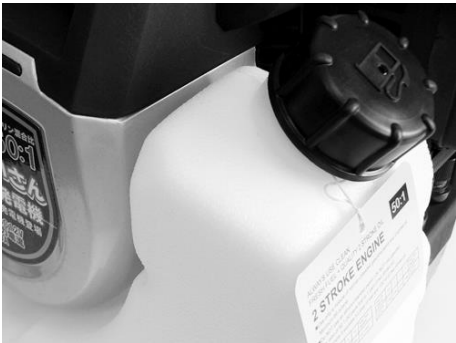
◆燃料タンクのキャップを外し「50:1」の混合ガソリンを入れます。
