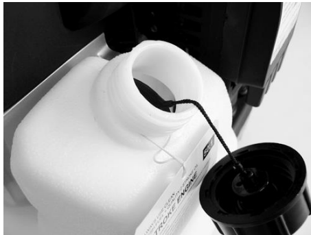
◆燃料タンクのキャップを外し「50:1」の混合ガソリンを入れます。
